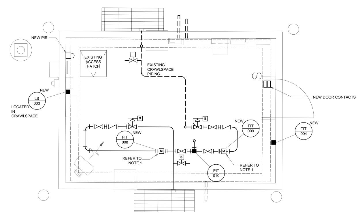
NEW BUILDING INSTRUMENTATION PLAN SCALE 1:25
