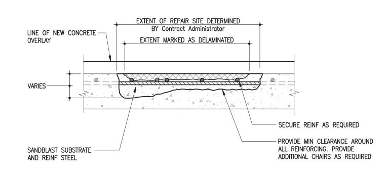
2 TYPICAL TOP SURFACE REPAIR DETAIL
