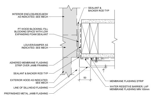
PLAN DETAIL - TYPCIAL MECHANICAL PENETRATION
