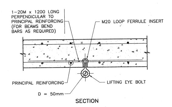
MAXIMUM LIFTING CAPACITY 6kN
