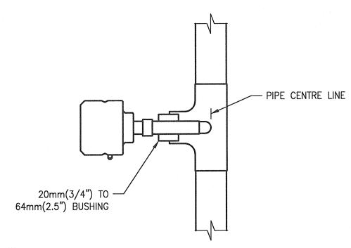
MINIMUM TEE SIZE 75mm. PROVIDE REDUCERS FOR LINES SMALLER THE 75mm.
