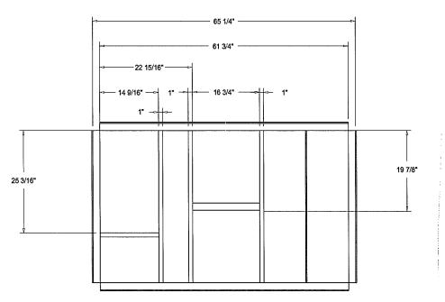
GAS / ELECTRICAL TOP VIEW ROOF TOP CURB
