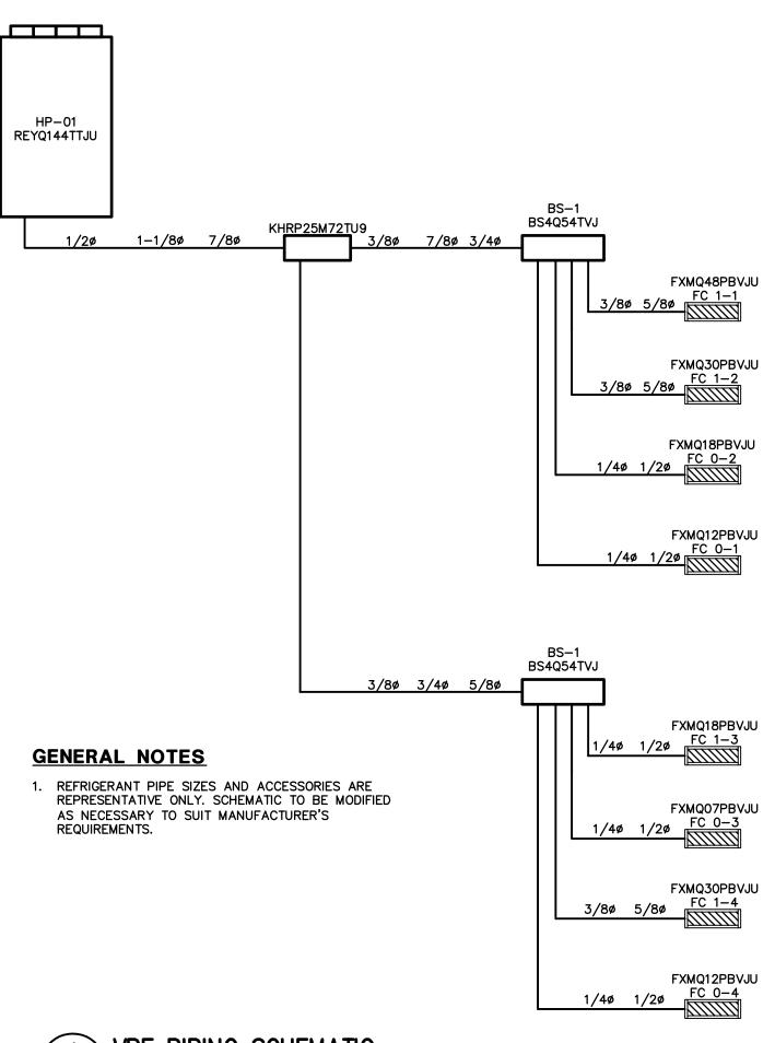
1 VRF PIPING SCHEMATIC M5.1 SCALE: NTS
