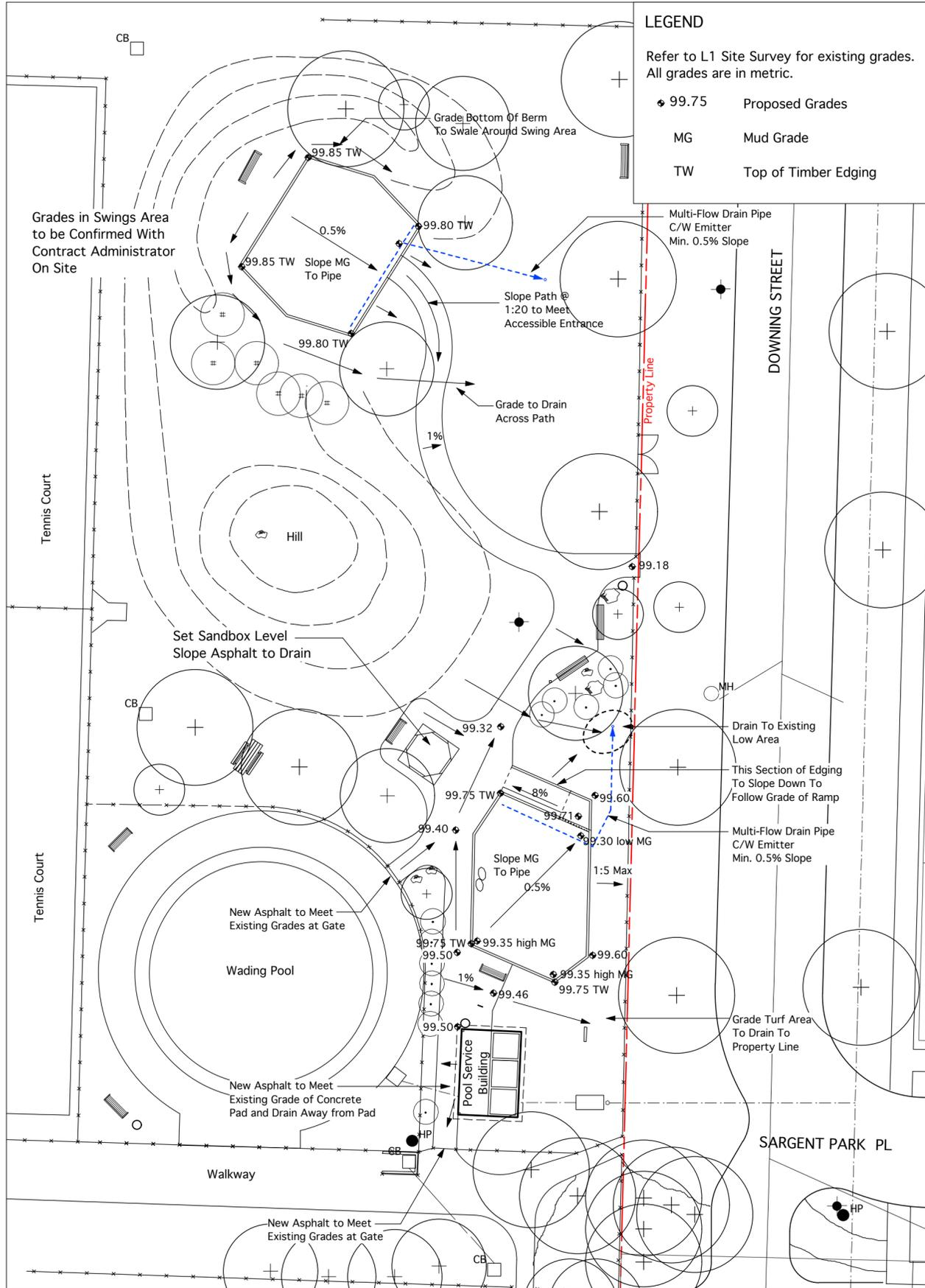
**1 GRADING SCHEMATIC PLAN**
