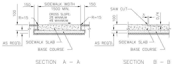
NOTE: SIDEWALK SLAB SURFACE WILL BE GIVEN A TEXTURED BROOM FINISH. NO EDGER MARKS WILL BE LEFT.
