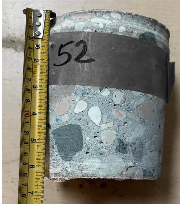
Fleetwood Rd, EBL ++ , Core 52 (Concrete Thk 160mm)
