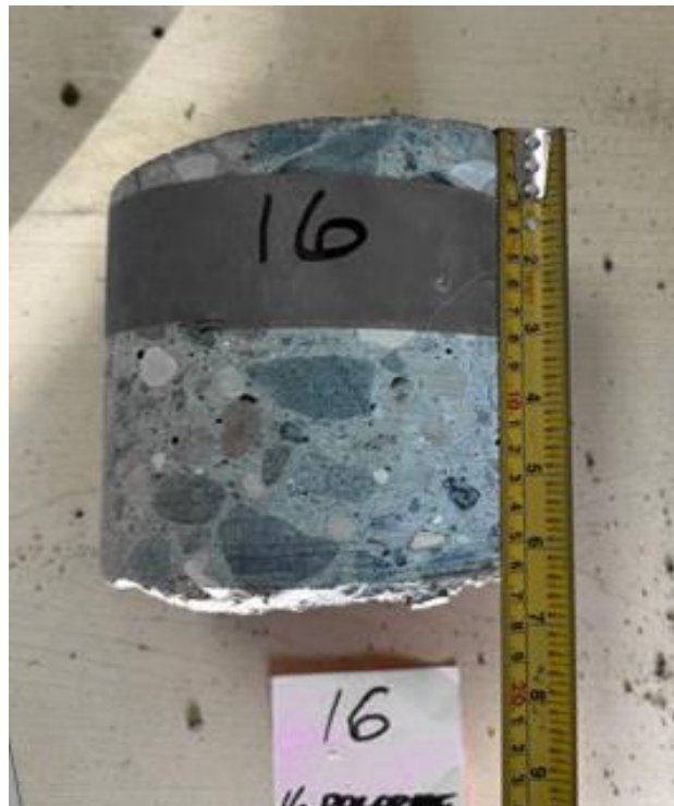
Delorme Bay, SBL ++ , Core 16 (Concrete Thk 150mm)
