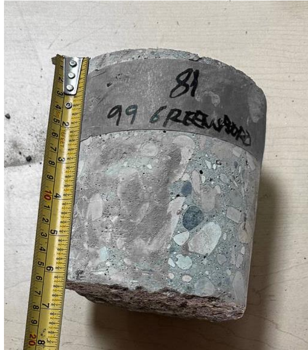
Greensboro Sq, EBL ++ , Core 81 (Concrete Thk 160mm)
